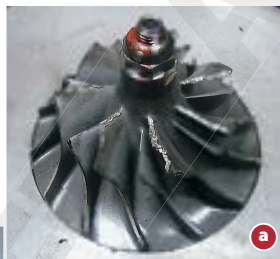
Bilder 104 a+b „Abgedreht“: Zerstörtes Verdichterrad (oben) sowie defektes Turbinenrad (links). Bilder: Motair
