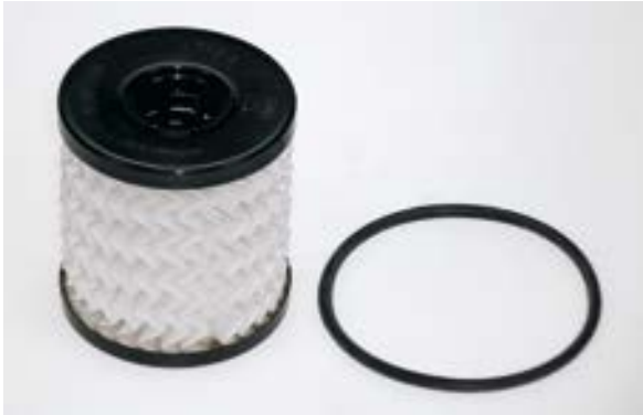
Bild 85 Ölfiltereinsatz mit Lamellenfilter: Aufgrund der von Sogefi entwickelten ‚Chevron-Falttechnologie‘ können Partikel mit einem Durchmesser bis zu 4 µm ausgefiltert werden ohne die Durchflussleistung zu beeinflussen. So ist laut Sogefi eine zuverlässige Motorleistung während der gesamten Nutzungszeit plus ein wirksamer Turboladerschutz gewährleistet. Bild: Sogefi
