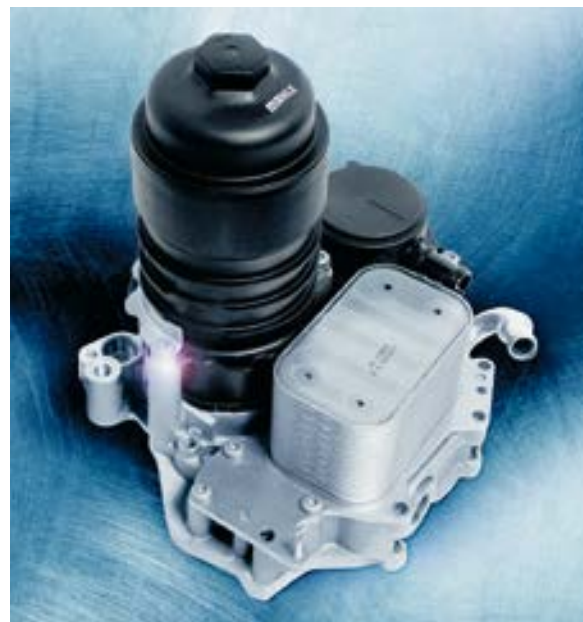
Bild 81 Hybridmodul – Ölfiltration, Ölkühlung, Ölnebelabscheidung: Die Filterbaugruppe besteht aus einem Deckel, einem Gehäuse, dem Filterelement mit Vollkunststofffilter und einem Filterumgehungsventil mit integrierter Verklüppung für den Ölfiltereinsatz. Bild: Mahle
