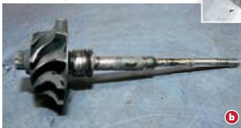
Bilder 104 a+b „Abgedreht“: Zerstörtes Verdichterrad (oben) sowie defektes Turbinenrad (links). Bilder: Motair
