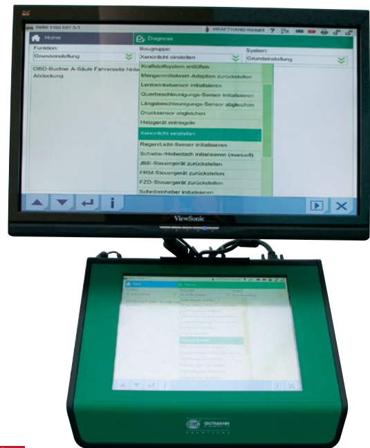
Bild 74 Universell: Hersteller- und Mehrmarkenscantoos ermöglichen über den Stellgliedertest das Prüfen von Funktionen moderner Lichttechnik. Außerdem sind sie für die Grundeinstellung von Xenonscheinwerfern notwendig. Bild: Blenk
