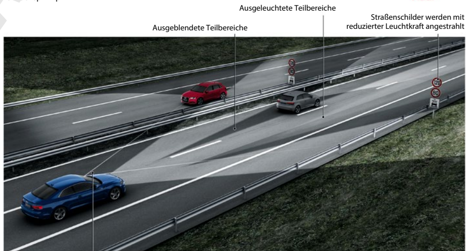
Sichtfeld der Frontkamera erkennt entgegenkommende und vorausfahrende Fahrzeuge
