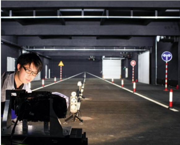
Bild 33 Künstliche Straße: Ein Lichtkanal ist bei der Entwicklung moderner Scheinwerfer unerlässlich. Bild: ZKW
