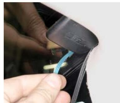
Jetzt wird die Kabel-Öse der Antennen-Stromversorgung an einem Massepunkt oder an einer Schraube des metallenen Armaturenbrett-Querträgers angeschraubt. Die Plus- und die Antennen-Leitung sind zum DAB-Interface zu führen und in kurzen Abständen mit Kabelbindern zu sichern.
