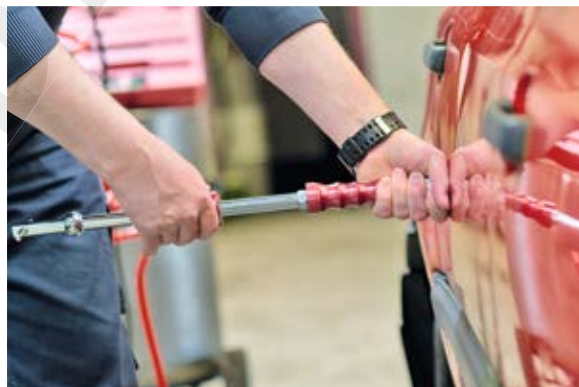
Bild 24 Zug- oder Gleithammer: Auf den angehefteten Klebepin wird die Aufnahme des Zugschweißgeräts aufgeschoben und gesichert. Nun kann durch Ziehen am Griff und dem dosierten Einsatz des Gleitgewichtes die Delle herausgezogen werden. Bild Berner/HBC
