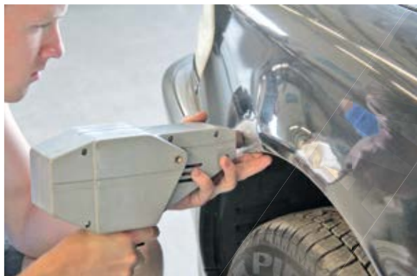
Bild 23 Pin-Handschweißgerät: Mit dem Handschweißgerät heftet der Kfz-Profi die Zugpin am blanken Blech an. Der Massekontakt zum Schweißen erfolgt an der Spitze.
