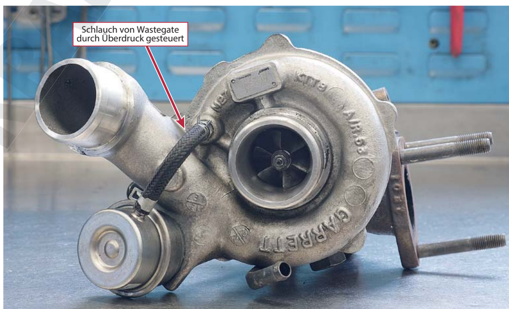
Bild 14 Wastegate mit Überdruckregelung. Der Ladedruck betätigt hier über einen Schlauch die Steuerdose beziehungsweise die Wastegateklappe. Bild: Mario Köhler
