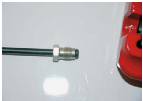
4.29 Bördelung Schritt 4: Nach sauber ausgeführter Arbeit kann die Verschraubung eingesetzt werden.
