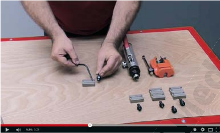
4.25 Anwendungs-video: Bördeln einer Bremsleitung. Bilder: Blenk
