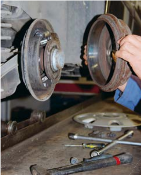
4.32 Erneut im Rennen: Insbesondere bei Kleinwagen setzen die Automobilhersteller wieder vermehrt auf die Trommelbremse. Technisch ausgereift und mit gesetzlich vorgeschriebenen Fahrdynamikprogrammen kompatibel, ist die Trommelbremse an der Hinterachse eine wartungsfreundliche Alternative zur Scheibenbremse. Bild: März
