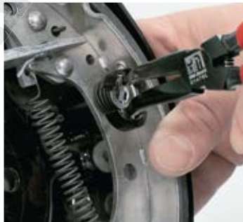
4.37 Federtellerzange ,01476L': Geeignet für Federteller von 7 bis 30 mm, SW-Stahl, Remscheid, Tel. 0 21 91 / 4 64 38-0, www.swstahl.de. Bild: SW-Stahl
