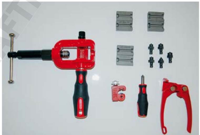
4.24 Bördelsatz: Einzelkomponenten wie verschiedene Bördeldorne, Spannklötze, eine Handspindel, eine Feststellschraube mit ein Grundkörper, ein Rohrabschneider sowie ein Entgrater.
