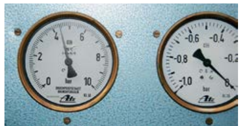
4.20 Mindestens 4 – 5 bar: Niederdruck-Prüfung am Fahrzeug.
