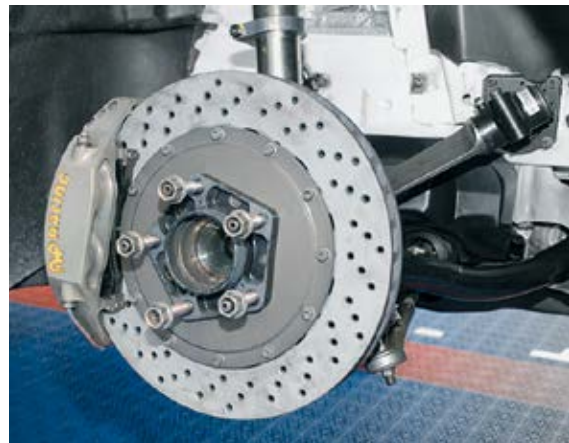
4.39 Motorsport: Bremsanlage mit Scheibe und Mehrkolben-Festsattel. Bild: Blenk
