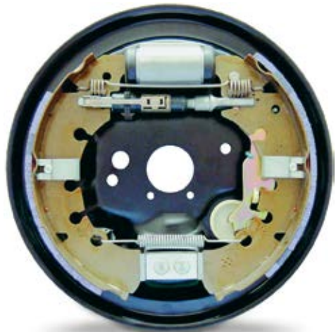
4.33 Klassiker mit Potenzial: Für eine Vielzahl von Fahrzeugen sind Trommelbremsen im Vergleich zu Scheibenbremsen die günstigere Lösung an der Hinterachse. Zudem ist die Integration der Handbremse relativ einfach. Bild: Continental
