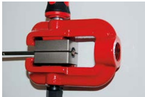
4.26 a+b Bördelung, Schritt 1: Die Leitung wird zwischen die beiden Spannklötze mithilfe des Grundkörpers und dem Feststeller eingespannt. Hier: vorne bündig zu den Spannklötzen (siehe Bild rechts).
