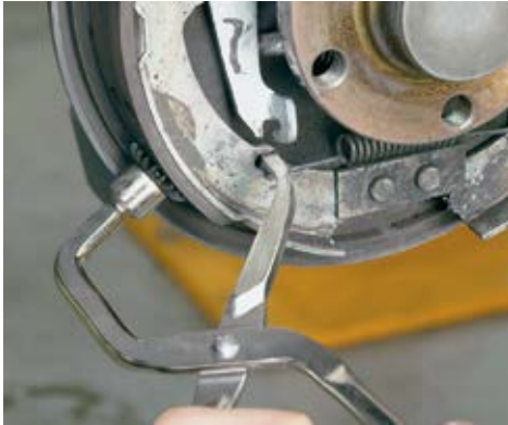
4.38 Nicht zweckentfremden: Spezialwerkzeuge ersetzen die früher verwendeten Schraubendreher und Kombizangen – etwa, um ein Beschädigen der Bremskomponenten, insbesondere das Überdehnen der Rückzugfedern, zu verhindern. Bild: SW-Stahl
