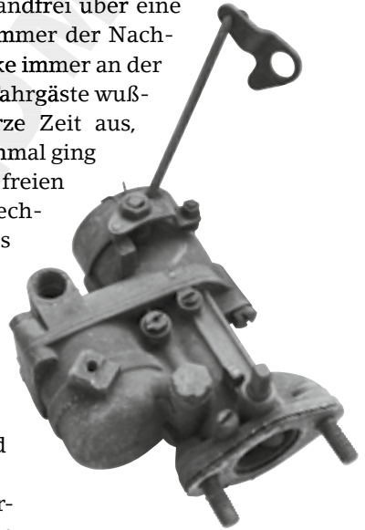
Sorex 26 VFIS: Verbaut u.a. im 24-PS-Käfer. Bild: Blenk
